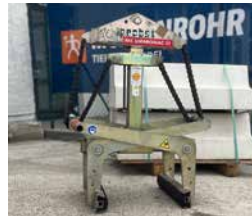
Verlegezange für Kasseler Borde
